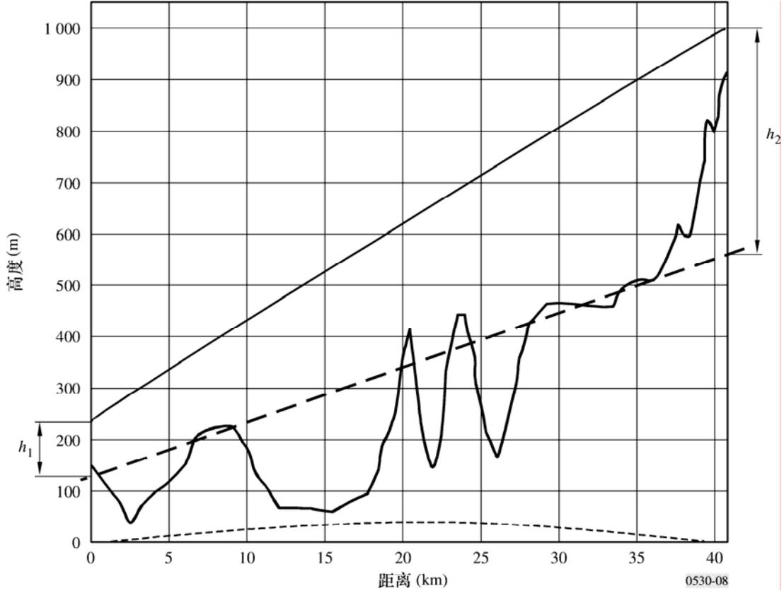
步骤3: 对于有效 $k$ 系数范围从 $k_e$  (99.9%)到无穷大 (见第2.2.2节; 在实际中可以选择大的 $k$ 值如 $k = 1.0 \times 10^9$ ), 用下式计算每一个可能的反射面分别距离站点1和站点2的距离 $d_1$ 和 $d_2$  (见注2):
