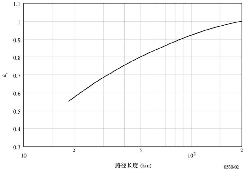
步骤3: 用第2步得出的 $k_e$ 值计算天线高度和下面的菲涅耳区余隙半径:
