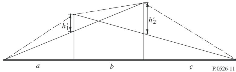
如果其中一个刀刃形障碍物占主导地位（见图12），则第一绕射路径由距离 $a$ 、 $b+c$ 和高度 $h_1$ 确定，第二绕射路径由距离 $b$ 、 $c$ 和高度 $h_2$ 确定。
