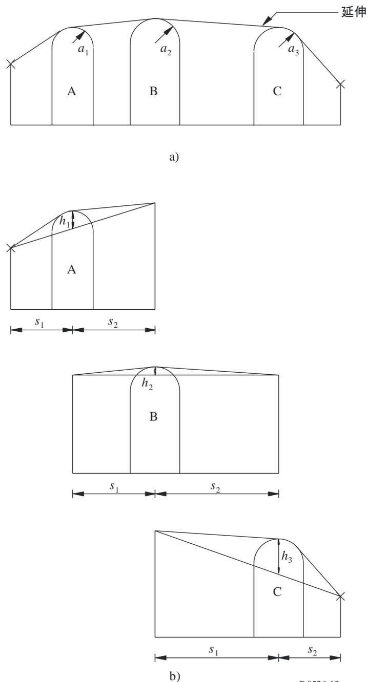
类似地，图13中每个圆柱体的高度 $h$ 是在垂直方向上测量得的、从圆柱体顶点到连接相邻顶点或终端的直线之间的距离。每个圆柱体的 $h$ 值对应于图8c)中的 $h$ 。又，对于近乎水平的射线，圆柱体高度可按垂直线计算，而对于较陡的射线角度，需要对其圆柱体基线做出法线以计算 $h$ 。
