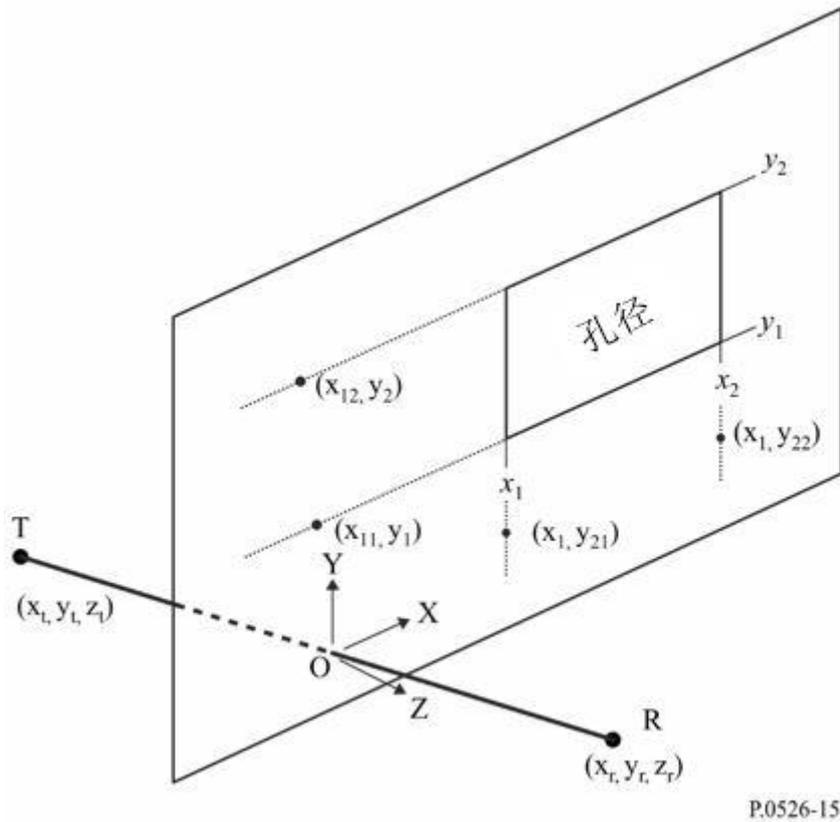
孔径刀刃的位置 $x_1$ 、 $x_2$ 、 $y_1$ 和 $y_2$ 以直角坐标示出，原点处于自坐标为 $x_t$ 、 $y_t$ 、 $z_t$ 的发射机 $T$ 到坐标为 $x_r$ 、 $y_r$ 、 $z_r$ 的接收机 $R$ 的直线穿过 $X$ - $Y$ 平面的屏蔽面的交点处，电波传播并非一定平行于 $Z$ 轴。原点位于屏蔽面的平面上。
