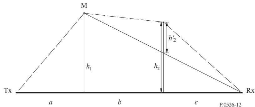
可以将单个刀刃形障碍物绕射理论构成的方法继续用于两个障碍物上。首先，由较高的 $h_1/r$ 比确定主障碍物M；其中 $h$ 如图12所示是直接路径 $TxRx$ 之上的主障碍物高度， $r$ 是公式（2）中给出的第一菲涅耳椭圆半径。于是，可应用于子路径 $MR$ 之上的副障碍物高度 $h_2$ 计算由副障碍物造成的损耗。考虑到两个刀刃形障碍物之间的间隔以及它们的高度，必须减去一个校正项 $T_c(\text{dB})$ 。 $T_c(\text{dB})$ 可由下面公式进行估值：
