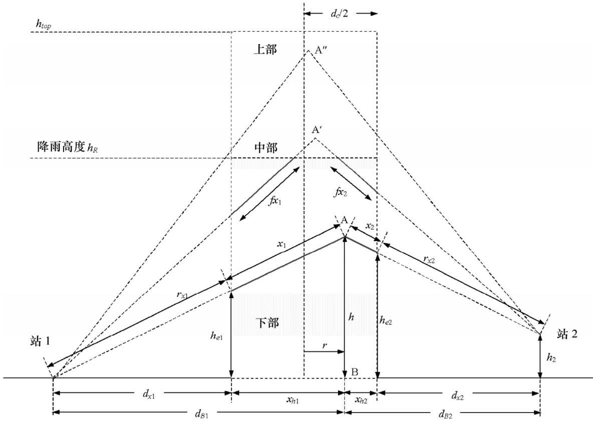
路径长度  $r_{x1}$ 、 $r_{x2}$ 、 $x_1$  和  $x_2$  是由几何条件按如下方法求出的。图 10 表示积分元  $A$  通过地平面投影点  $B$  的水平平面视图。这里，假设一开始站 2 的修正高度  $h_2$  为零。这一点后面加以考虑。
