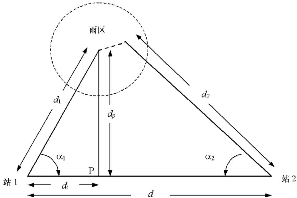
计算从站 1 到雨区中心的水平距离，雨区中心定义为在站 1 的主射束轴上正对着最接近的路径的那一点的下面的地面上的那一点：
