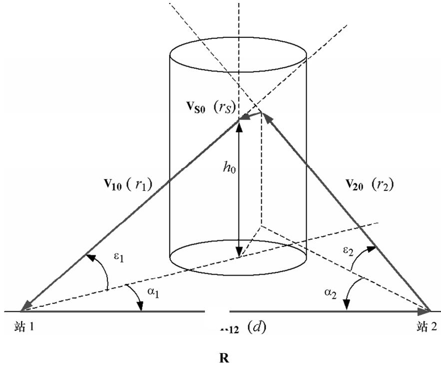
雨区的中心放在站 1 的主射束天线轴上，在两个天线射束之间最接近的途径的那一点处。按下面的步骤以矢量标记建立几何关系。
