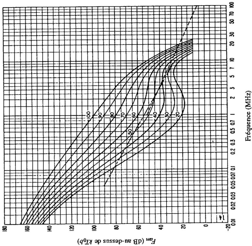
FIGURE 27b - Variation du bruit radioélectrique en fonction de la fréquence (Eté; 0000-0400 heure locale)
