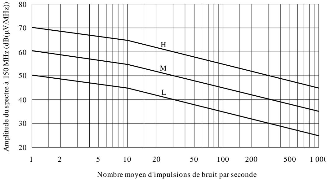
Pour des fréquences autres que 150 MHz, relever ou abaisser les courbes H, M et L conformément à la formule qui suit:
