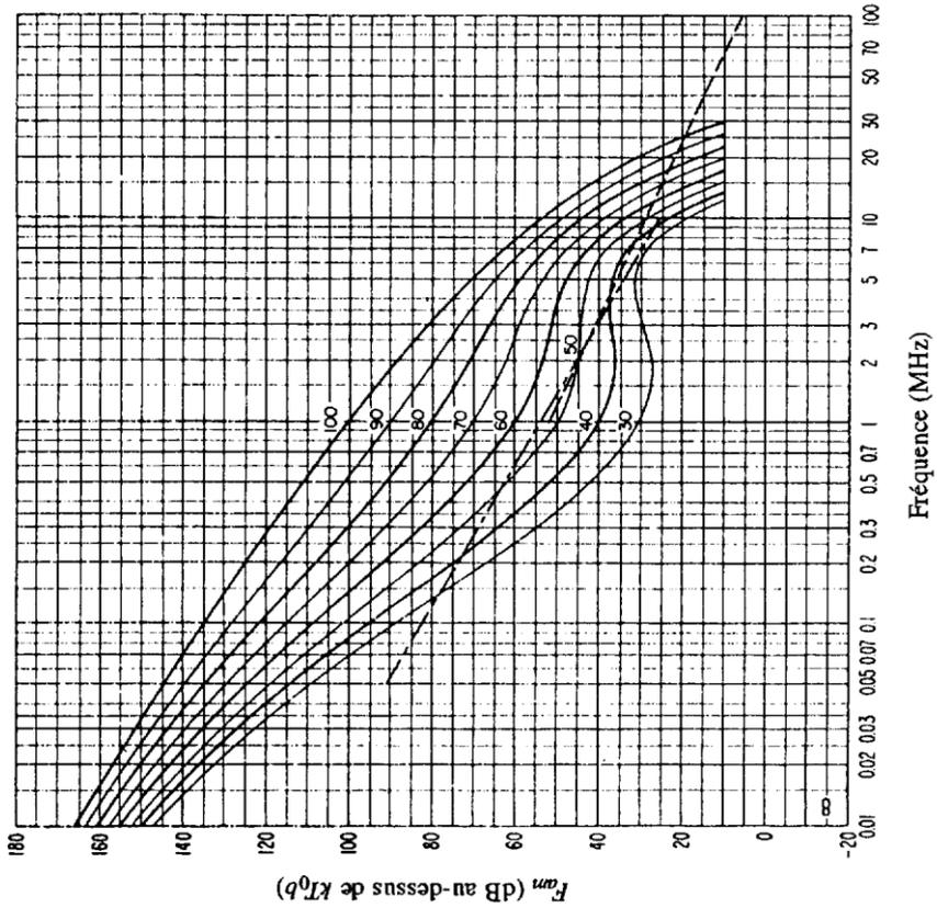
FIGURE 21b – Variation du bruit radioélectrique en fonction de la fréquence
