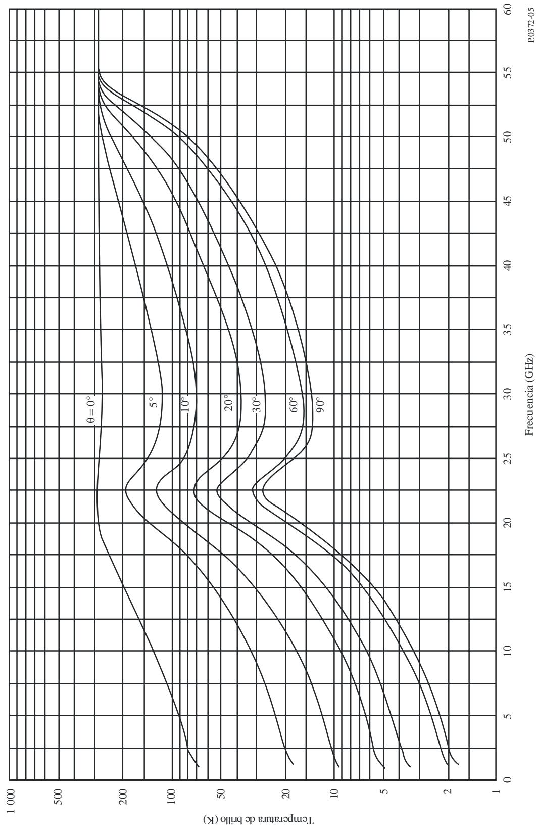
En las comunicaciones Tierra-espacio, si se conoce la atenuación de la señal procedente del transmisor del vehículo espacial, puede obtenerse una buena estimación de la temperatura de brillo para frecuencias comprendidas entre 2 y 30 GHz en esa dirección aplicando la siguiente fórmula:
