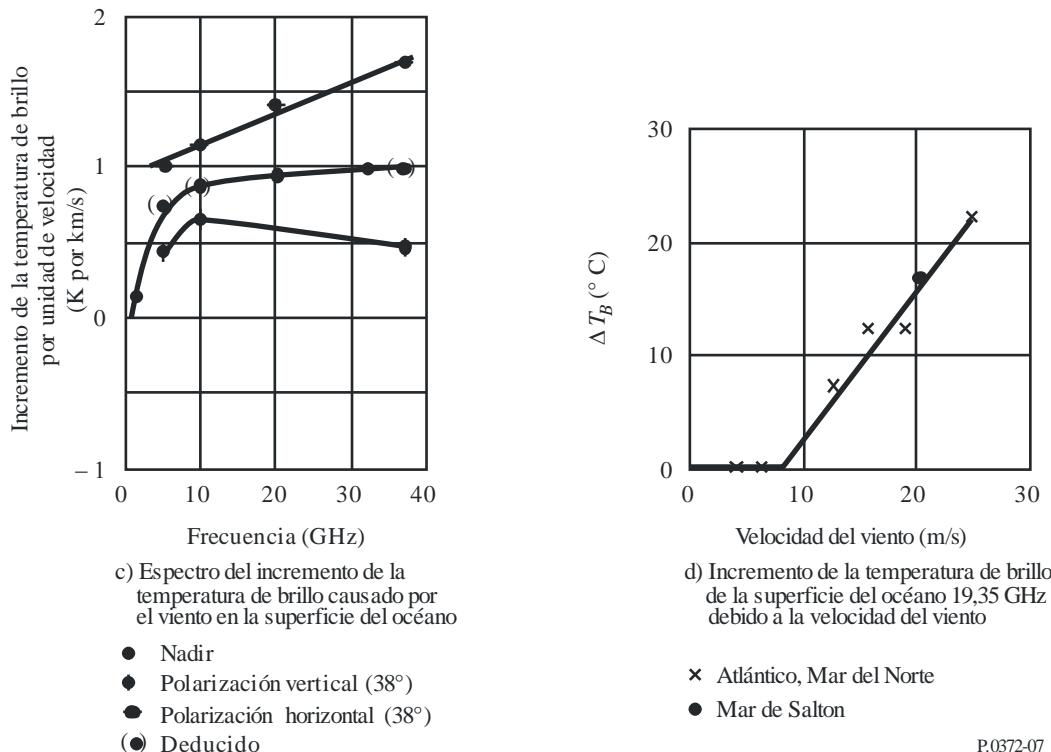
c) Espectro del incremento de la temperatura de brillo causado por el viento en la superficie del océano
