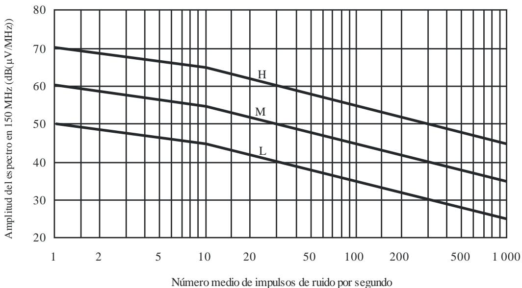
Para frecuencias distintas de 150 MHz, aumente o disminuya las curvas H, M y L, de conformidad con la fórmula que figura a continuación:
