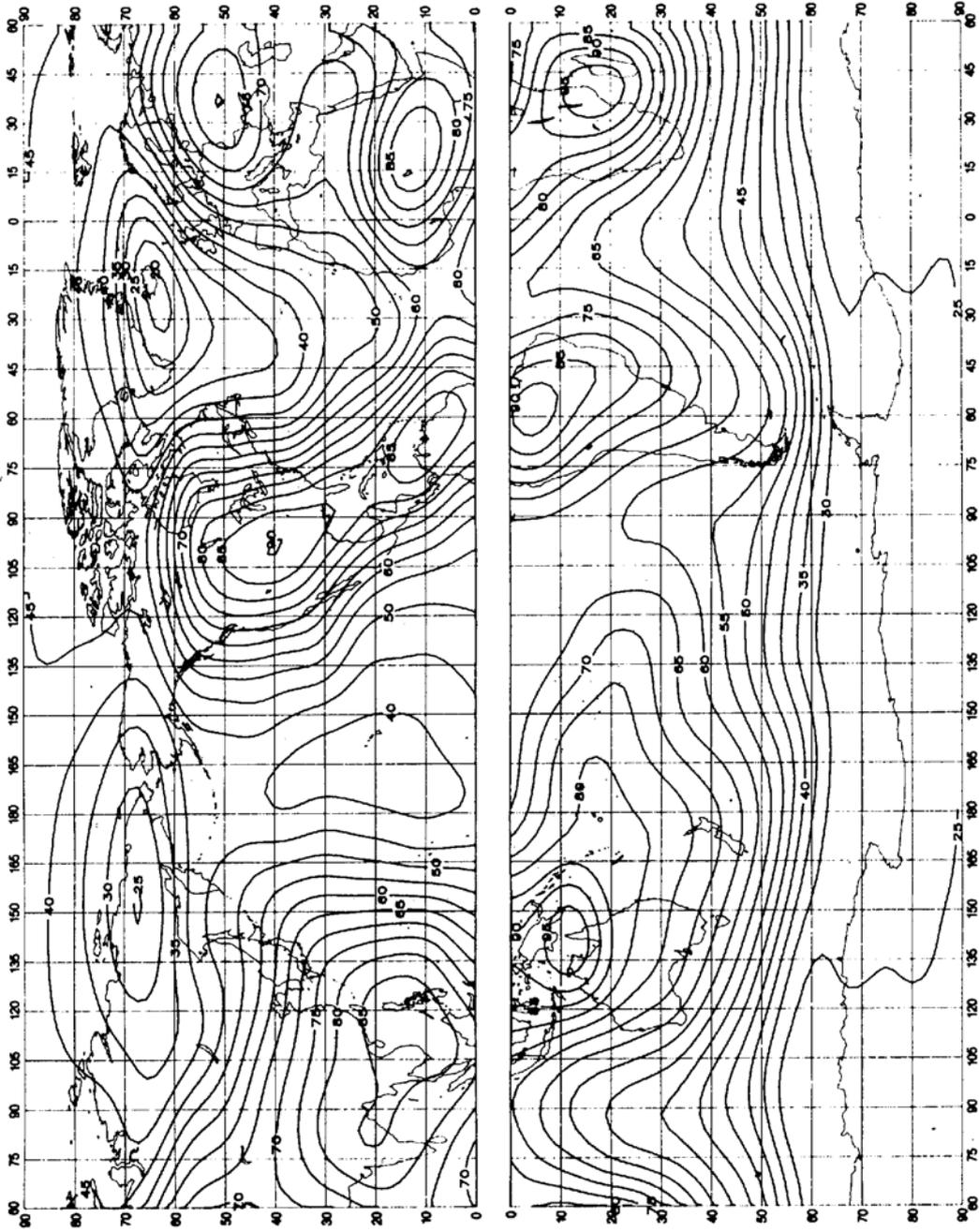
FIGURE 31a – Valeurs attendues du bruit atmosphérique radioélectrique,  $F_{fm}$ , en dB au-dessus de  $kT_{0b}$  à 1 MHz (Eté; 1600-2000 heure locale)
