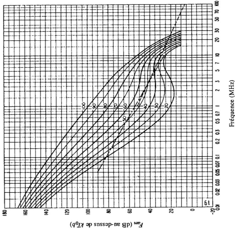
FIGURE 32b - Variation du bruit radioélectrique en fonction de la fréquence (Etié; 2000-2400 heure locale)
