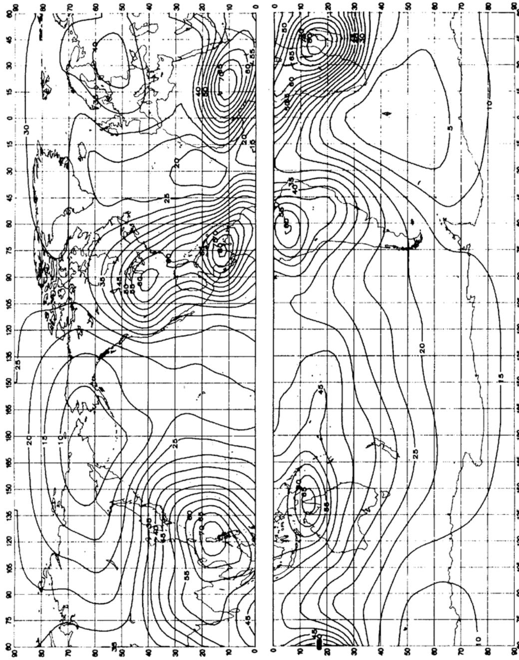
FIGURE 29a – Valeurs attendues du bruit atmosphérique radioélectrique,  $F_{am}$ , en dB au-dessus de  $kT_0b$  à 1 MHz (Ete; 0800-1200 heure locale)
