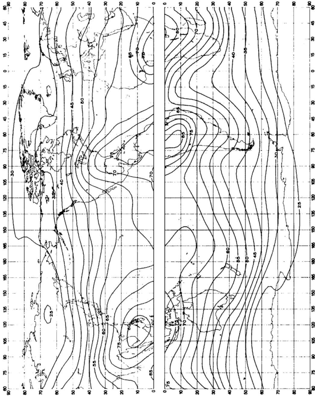
FIGURE 22a – Valeurs attendues du bruit atmospherique radioelectrique,  $F_{0.1}$  en dB au-dessus de  $kT_{0b}$  à 1 MHz (Printemps; 0400-0800 heure locale)
