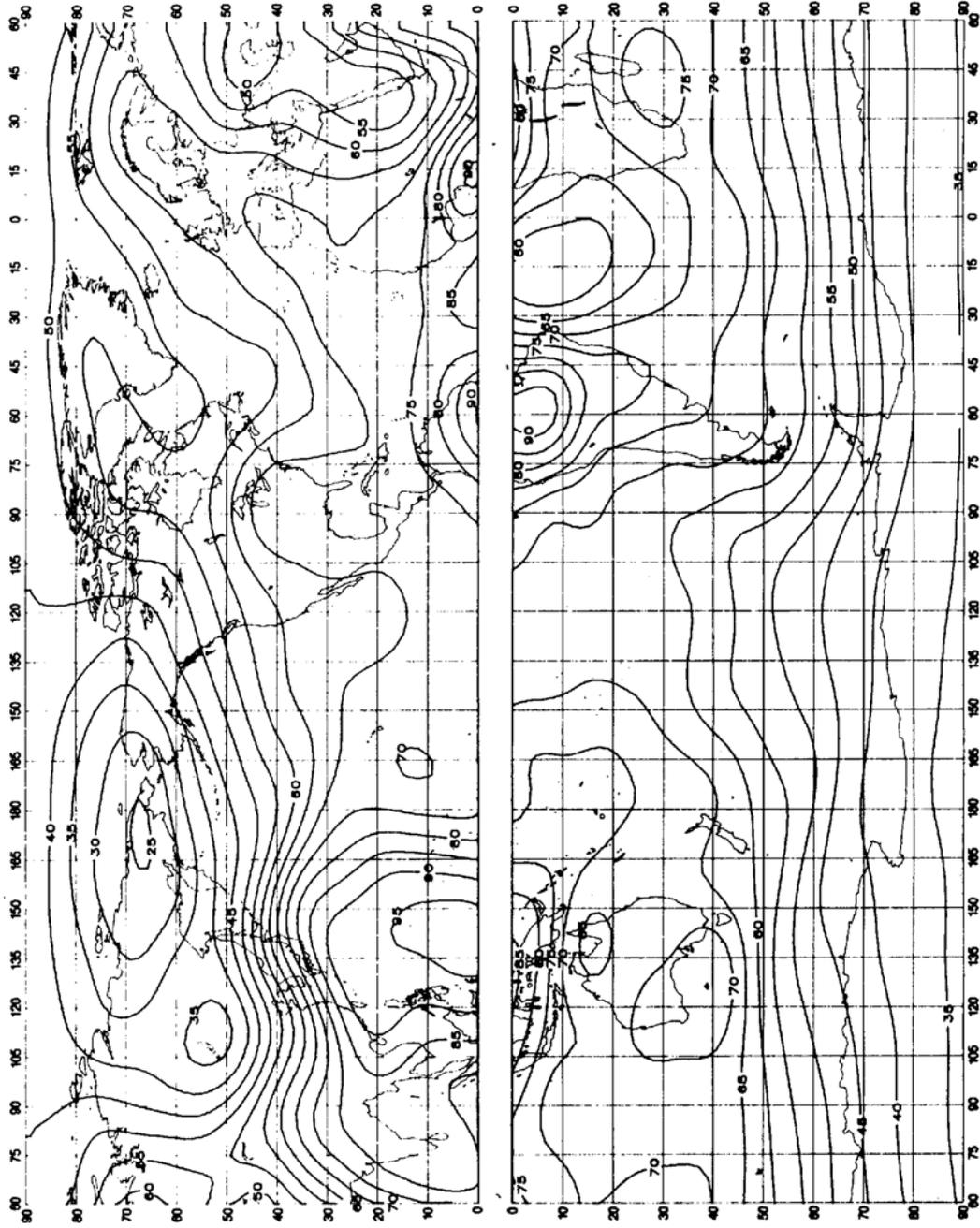
FIGURE 20a – Valeurs attendues du bruit atmospherique radioelectrique,  $F_{am}$ , en dB au-dessus de  $kT_{0b}$  à 1 MHz (Hiver, 2000-2400 heure locale)
