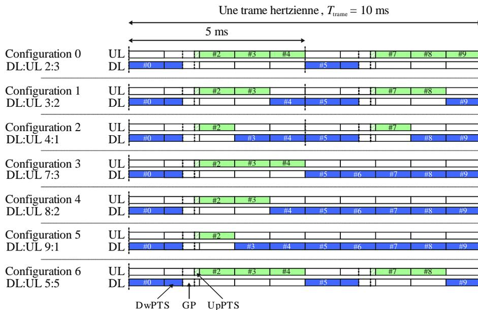
Les transmissions Sidelink utilisent la même structure de trame que la structure de trame qui est définie pour la liaison montante et la liaison descendante, lorsque les terminaux UE se trouvent dans la zone de couverture du réseau. Toutefois, les transmissions Sidelink sont limitées à un sous-ensemble des ressources en liaison montante dans le domaine temporel et dans le domaine fréquentiel.
