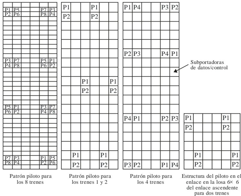
Para la subtrama que consta de 5 símbolos OFDM, se suprime el último símbolo OFDM. Para la subtrama que consta de 7 símbolos OFDM, se añade el primer símbolo OFDM como 7° símbolo OFDM. Para compensar los efectos de la interferencia del piloto entre sectores adyacentes o BS, se utiliza una estructura piloto entrelazada gracias al desplazamiento cíclico del patrón de base del piloto de modo que los pilotos de las células vecinas no se solapan.
