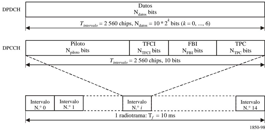
El parámetro  $k$  en la Fig. 61 determina el número de bits por intervalo DPDCH y guarda relación con el factor de dispersión SF del canal físico, dado que  $SF = 256/2^k$ . El factor de dispersión varía entre 256 y 4. En el caso del DPCCH del enlace ascendente, este factor siempre es igual a 256, es decir, hay 10 bits por intervalo DPCCH del enlace ascendente.
