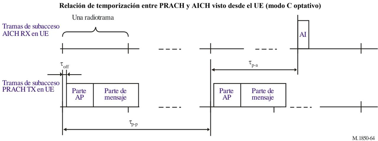
El desfase de transmisión  $\tau_{off}$  debe estar comprendido entre  $[-\tau_{off,m\acute{a}x}, +\tau_{off,m\acute{a}x}]$ , definido por el desfase de transmisión máximo  $\tau_{off,m\acute{a}x}$ . El parámetro desfase de transmisión máximo se indica en capas superiores.
