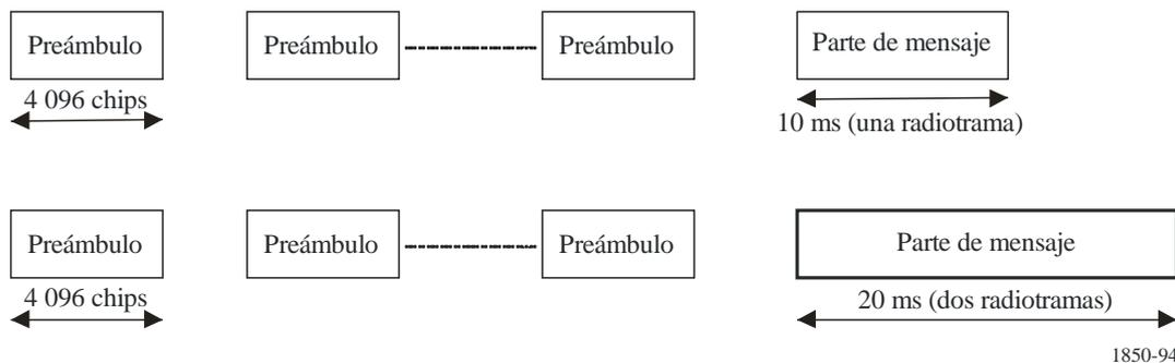
Cada preámbulo tiene una longitud de 4 096 chips y consiste en 256 repeticiones de una firma de 16 chips de longitud.
