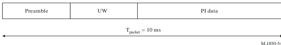
El campo de datos contiene el identificador de usuario de 24 bits y la parte CRC de 8 bits. Están codificados con una velocidad de código convolucional de 1/3 y perforados a 114 bits.
