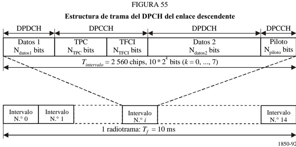
Para el enlace descendente, el DPDCH y el DPCCH se multiplexan en el tiempo dentro de cada radiograma y se transmiten con modulación MDP-4.
