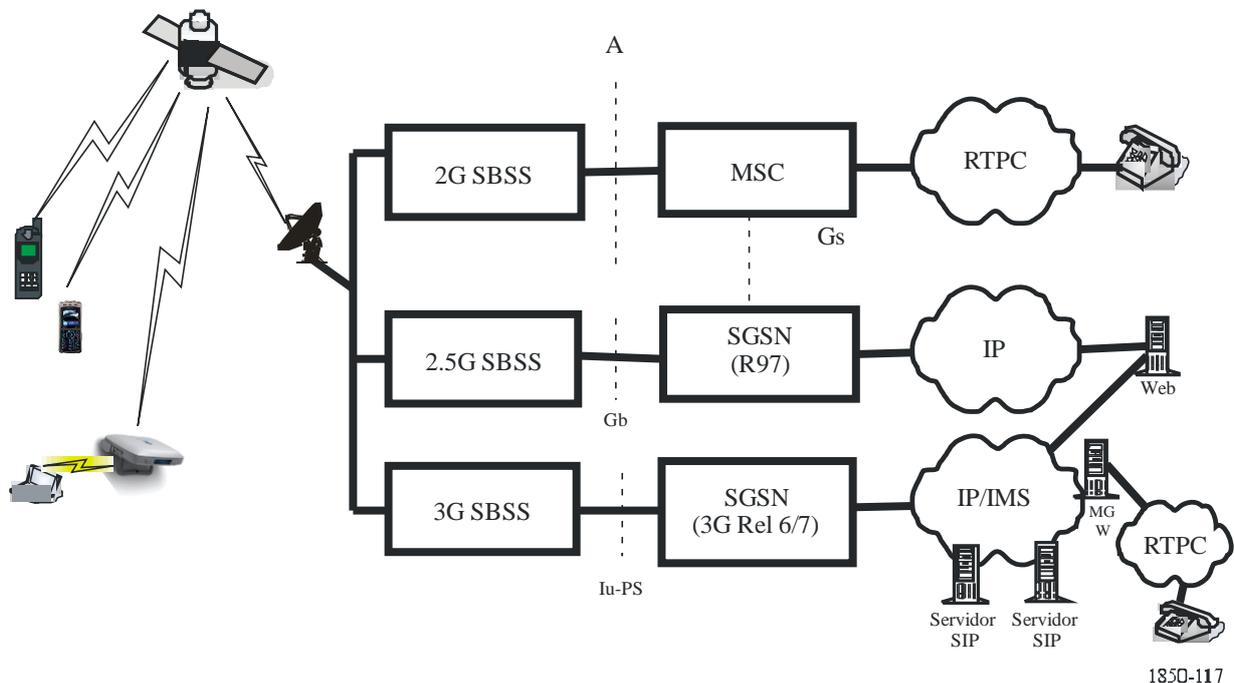
La GMR-1 3G funciona en modo DDF con anchuras de banda de canal de RF entre 31,25 kHz y 312,5 kHz, y ofrece una granularidad espectral más fina gracias a la compartición de espectro entre sistemas diferentes.
