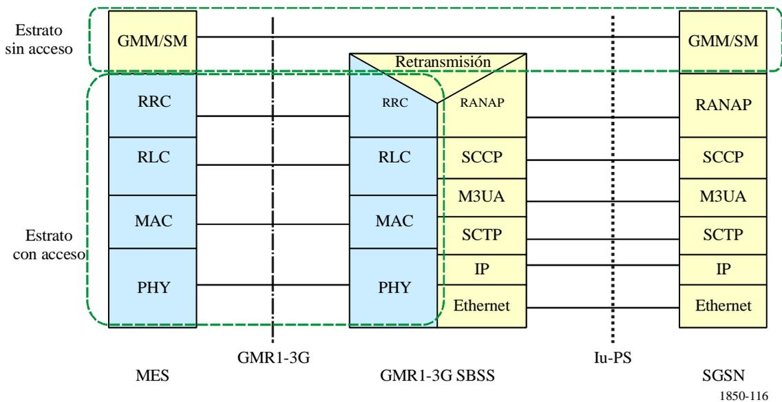
En la Fig. 83 se ilustran las arquitecturas de extremo a extremo que permite la utilización de la interfaz radioeléctrica GMR-1 3G con diferentes interfaces de red central. Cada operador seleccionará la opción arquitectónica que desee (A, Gb, Iu-PS) o una combinación de la misma.
