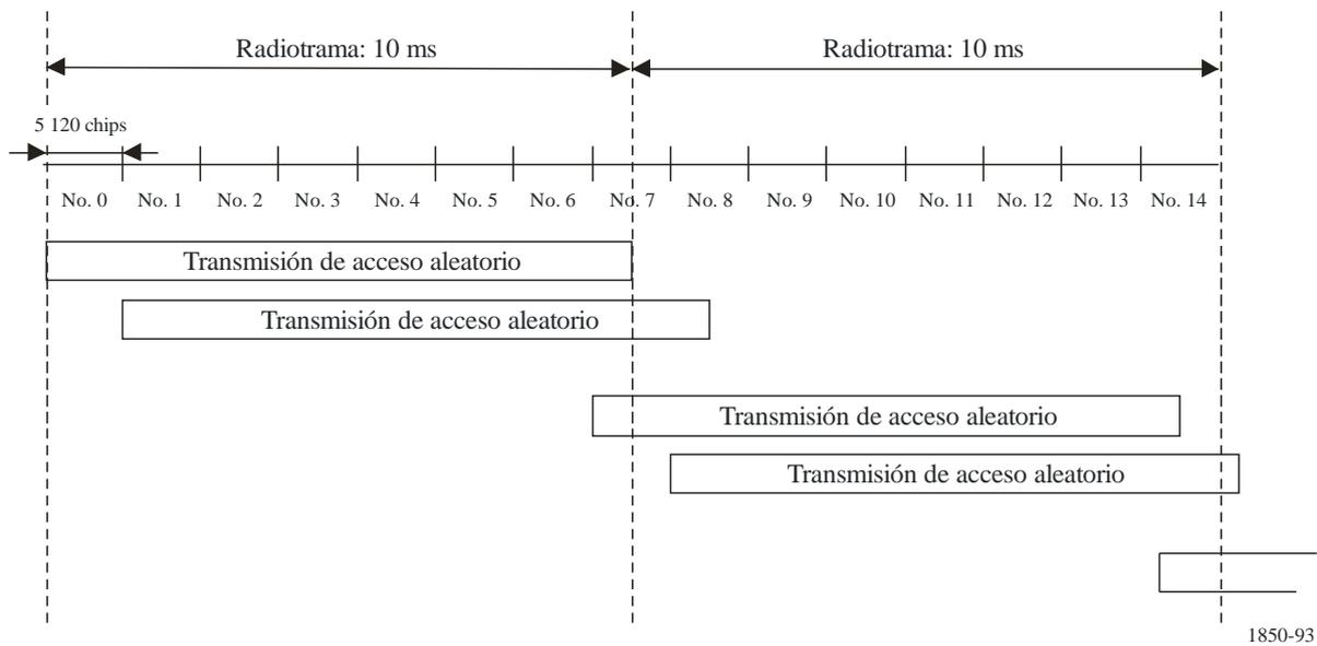
La transmisión de acceso aleatorio consta de un o varios *preámbulos* de 4 096 chips de longitud y un mensaje de 10 ms o 20 ms de duración.
