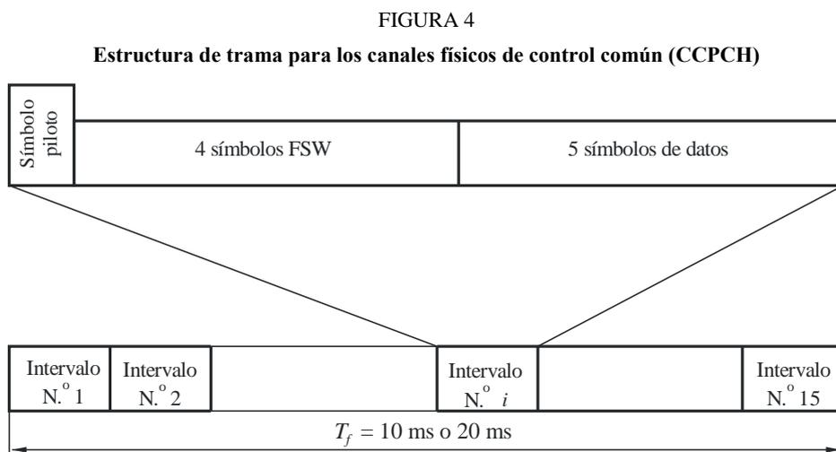
El código primario del canal CCPCH para este canal es el mismo en todos los haces y satélites y es conocido de todas las ETM. Se utilizan dos FSW; un FSW en todas las tramas excepto en la primera de cada MF en que se utiliza el otro FSW. Obsérvese que no se utilizan símbolos piloto en el CCPCH. La hipótesis consiste en utilizar el piloto común para dichos fines.
