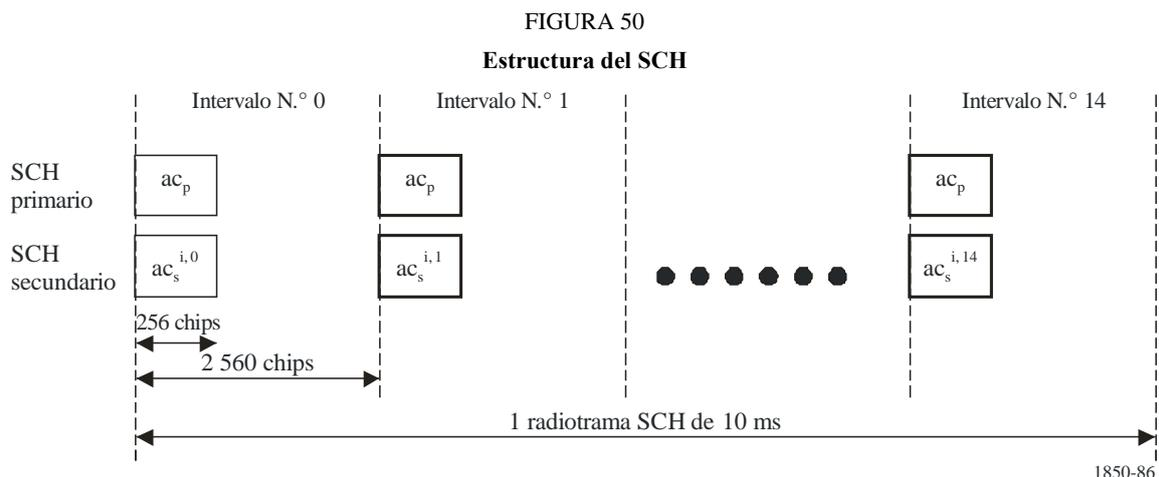
El SCH primario consiste en un código modulado con una longitud de 256 chips, el código de sincronización primario (PSC) indicado por  $c_p$  en la Fig. 50, que se transmite una sola vez en cada intervalo. El PSC es el mismo en cada haz del sistema.
