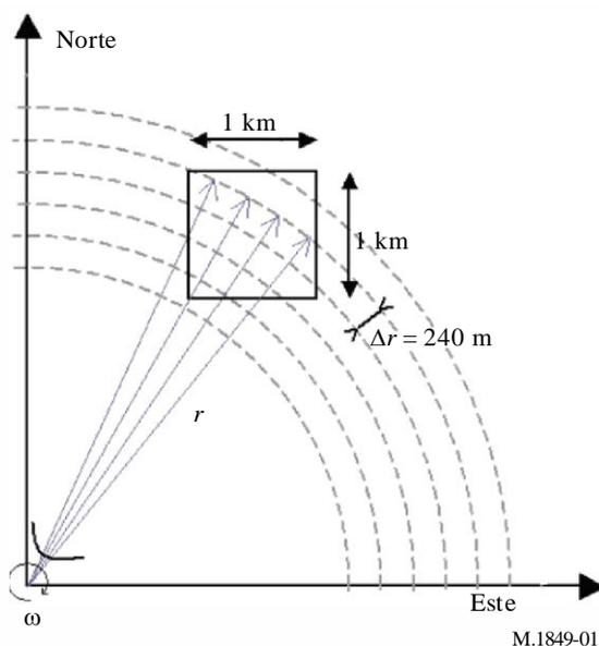
En consecuencia, el número de estimaciones por píxel varía de acuerdo con la distancia. Estos números están relacionados con la frecuencia de repetición de impulsos (PRF) media y la velocidad de rotación de la antena. Por término medio, con una velocidad de rotación de la antena típica de 6 grados/s, una PRF media de 333 Hz y una separación de ventanas de 240 m, se obtiene para 10 y 100 km unas 1 000 y 100 estimaciones, respectivamente, para un píxel de  $1 \text{ km}^2$ .
