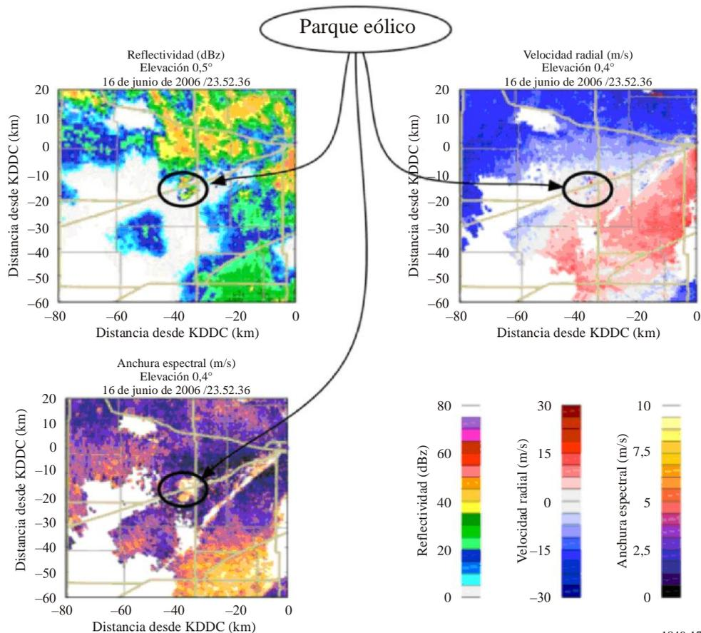
Sin previo conocimiento, sería muy difícil distinguir entre los ecos parásitos producidos por las turbinas eólicas y las tormentas. Como las aspas giran en un sentido o en otro con respecto al radar, cabe esperar una velocidad Doppler con un valor medio casi cero. Unas anchuras del espectro grandes reducirán la precisión de las estimaciones de la velocidad Doppler, como queda ilustrado en la Fig. 17 por pequeñas desviaciones con respecto al cero.
