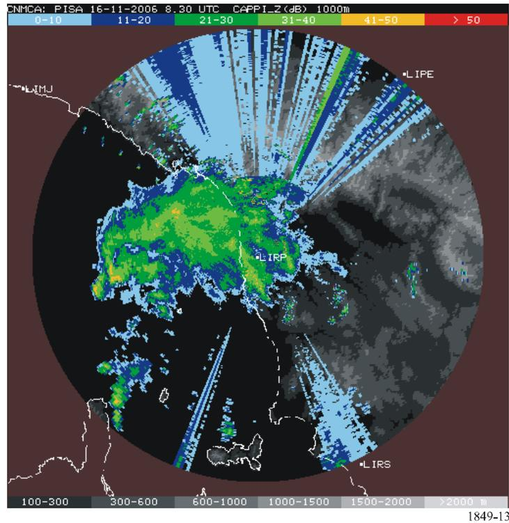
En el caso de una aplicación interferente que transmite señales impulsivas, y debido al principio de las mediciones de lluvia y viento que se basan en calcular la media de numerosos impulsos de radar, parece probable que la PRF de las ventanas de los radares meteorológicos (anchura de impulso) y la fuente de interferencia serán quienes determinen la repercusión sobre los radares meteorológicos.
