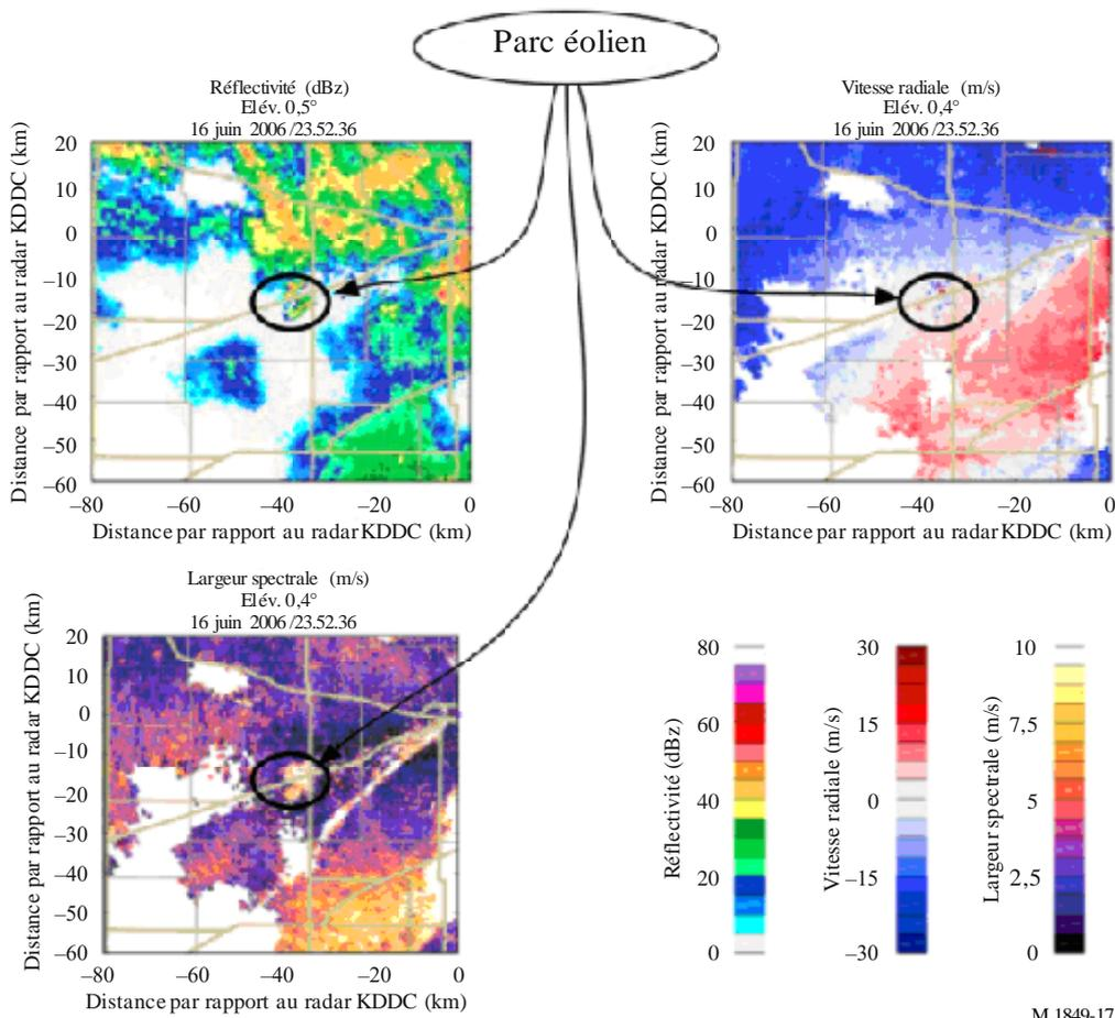
Sans connaissance préalable, il serait extrêmement difficile de faire une distinction entre le fouillis radar causé par les éoliennes et les orages. Etant donné qu'en tournant, les pales s'éloignent et se rapprochent du radar, la vitesse Doppler moyenne devrait être proche de zéro. Les grandes largeurs spectrales réduiront la précision des estimations de vitesse Doppler par de petits écarts par rapport à zéro (voir la Fig. 17).
