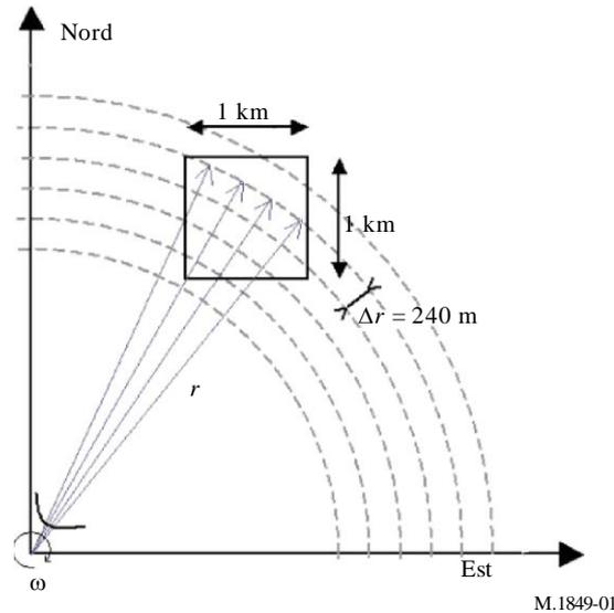
En conséquence, le nombre d'estimations par pixel varie en fonction de la distance. Il est lié à la fréquence de répétition des impulsions (PRF) moyenne et à la vitesse de rotation de l'antenne. En moyenne, avec une vitesse de rotation d'antenne de 6 degrés/s, une PRF moyenne de 333 Hz et un espacement des fenêtres de 240 m, on obtient environ 1 000 estimations à 10 km et environ 100 estimations à 100 km, pour un pixel de 1 km<sup>2</sup>.
