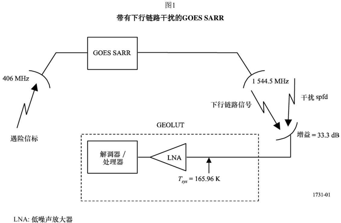
为了达到 $5 \times 10^{-5}$ 的BER，在GEOLUT解调器处的每比特能量与噪声加干扰的密度之比( $E_b/(N_0 + I_0)$ )必须等于或大于8.8 dB。这一分析确定了规定相对于GEOLUT天线输入的spfd的宽带类噪声干扰的最大量在无恶化总链路 $E_b/(N_0 + I_0)$ 不差于8.8 dB时是可以调节的。
