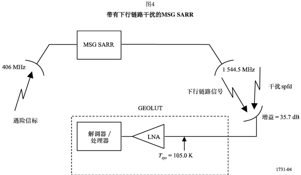
EPIRB信号相对于宇宙飞船有5°的仰角。当不存在外部干扰源时，总C/N<sub>0</sub>为27.4 dB-Hz，这相当于1.4 dB的E<sub>b</sub>/N<sub>0</sub>。考虑实际实施和信标数据解调损耗以及GEOLUT的处理增益，得出8.9 dB的E<sub>b</sub>/N<sub>0</sub>的有效比。由于信道要求总的E<sub>b</sub>/(N<sub>0</sub> + I<sub>0</sub>)至少8.8 dB才能可靠地满足最低性能，下行链路上的宽带干扰的累积如果使总的载波对噪声加干扰密度的比降低了0.1 dB以上就不能接受了。
