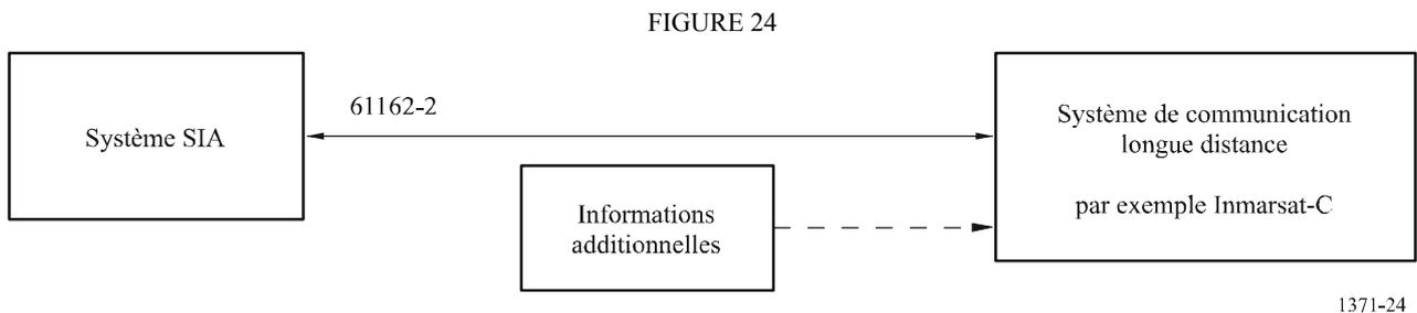
Etant donné que les systèmes de communication longue distance n'ont pas d'interface CEI 61162-2, la configuration telle que montrée dans la Fig. 25 peut être utilisée comme solution intérimaire.
