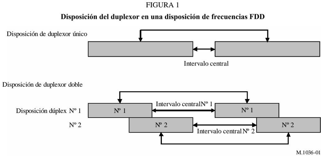
Al haber un solapamiento fijo entre las disposiciones dúplex N° 1 y N° 2, se puede utilizar el equipo común para cumplir todos los requisitos operativos del sistema. Probablemente el tamaño del solapamiento sea igual en todas las configuraciones y se decida en función del diseño del filtro al determinar el plan de bandas.
