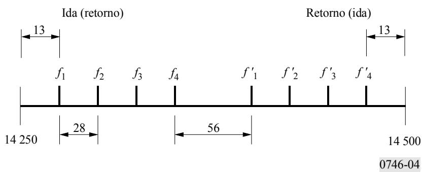
NOTA 1 – Debido a la estrechez de las bandas de guarda centrales y laterales, los canales 1 y 4 no son adecuados para la explotación a 34 Mbit/s con una separación de canales de 28 MHz. Por consiguiente, la utilización de esos canales queda limitada a la televisión analógica de 625 líneas o a los sistemas digitales de baja capacidad, con una subdivisión de los canales de 7 y 3,5 MHz similar a la adoptada en el § 10 de la Recomendación UIT-R F.497, Alternativas I y III.
