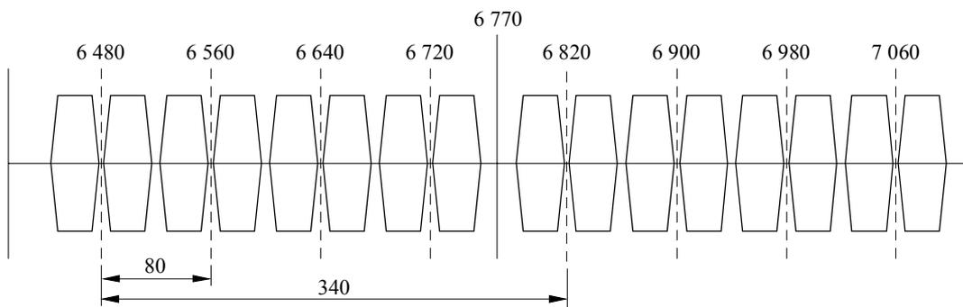
b) Disposición de canales preferida si no es necesario mantener la compatibilidad con los sistemas de radioenlaces analógicos
