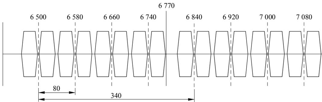
a) Disposición de canales preferida si es necesario mantener la compatibilidad con los sistemas de radioenlaces analógicos
