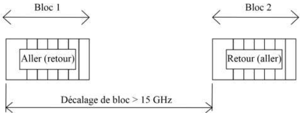
FIGURE 5 Exemple d'utilisation du duplex FDD dans des blocs appariés pour des canaux aller-retour symétriques
