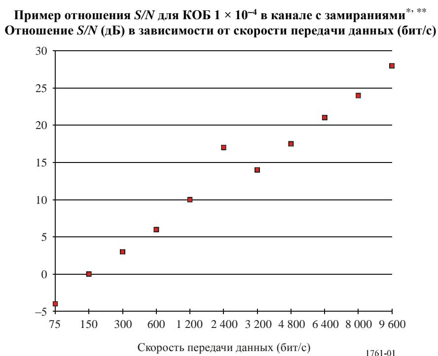
\* Два независимых рэлеевских тракта с замираниями с равной средней мощностью, с фиксированной задержкой в 2 мс между трактами, с замиранием в 1 Гц.
