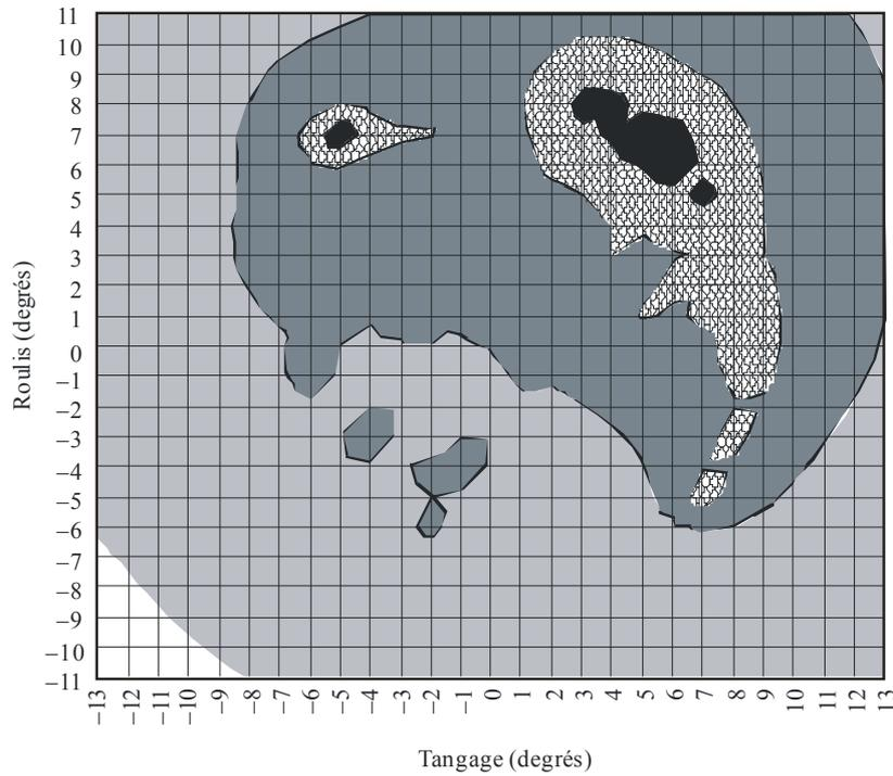
Niveau maximal du brouillage cumulé = -148 dB(W/MHz)
