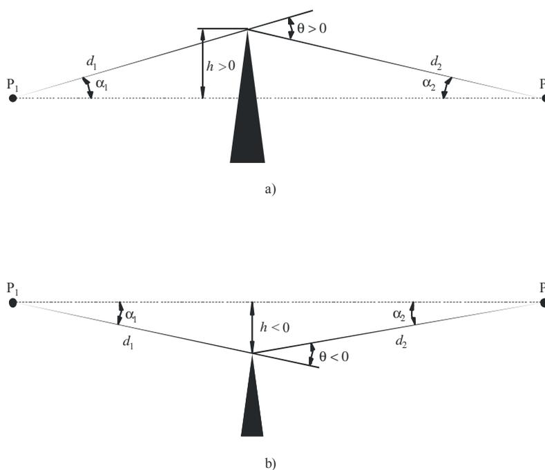
$\alpha_1$  et  $\alpha_2$ : angles séparant, à partir d'une extrémité, le sommet de l'arête et l'extrémité opposée
