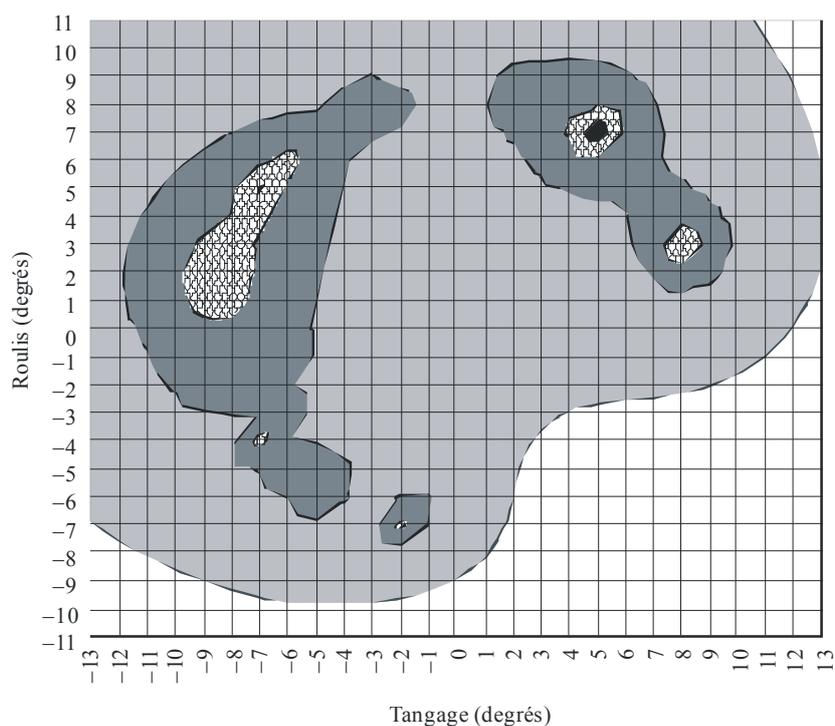
Niveau maximal du brouillage cumulé = -149,5 dB(W/MHz)
