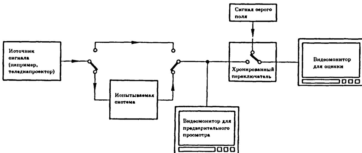
Участники испытаний наблюдают видеомонитор для оценки, на который сигнал подается через хронированный переключатель. На вход этого переключателя сигнал может поступать либо непосредственно от источника сигнала либо через испытываемую систему. Наблюдателям предъявляют ряд испытательных изображений или последовательностей изображений. Они следуют попарно, причем первое в паре приходит непосредственно от источника, а второе является тем же самым изображением, прошедшим через испытываемую систему.
