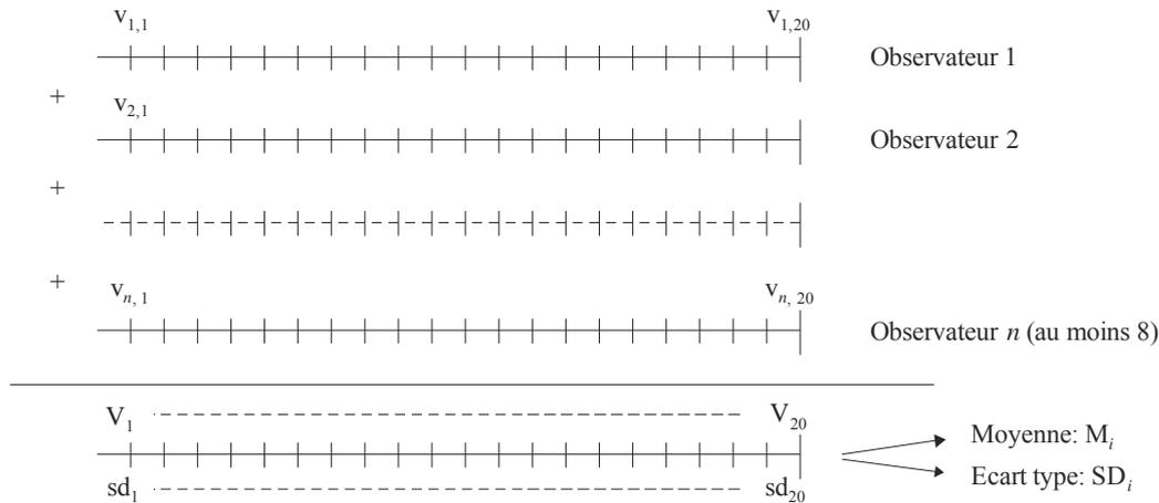
b) Calcul de la moyenne,  $M$ , et de l'écart,  $SD$ , par séquence de notation d'une seconde pour chaque combinaison  $VS \times TC$
