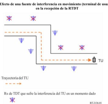
FIGURA 1 Efecto de una fuente de interferencia en movimiento (terminal de usuario)
