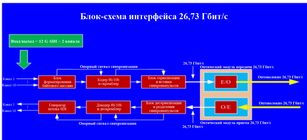
Общая блок-схема последовательного интерфейса 26,73 Гбит/с
