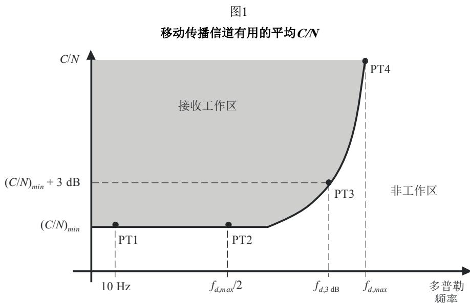
移动接收中，有用平均 $C/N$ 的最小值（ $C/N_{min}$ ）及平均 $C/N$ 等于 $C/N_{min}+3$  dB的多普勒频率和最大多普勒（速度）限值在表112中给出。 $C/N_{min}+3$  dB时的速度限值以三个频率值（65 MHz、200 MHz、500 MHz和700 MHz）给出。平均 $C/N$ 值、 $C/N_{min}+3$  dB，适合于计算有用场强。各数值均基于表110中示出的“典型市区”内的典型信道特性情况。质量准则是与5分钟的误码秒百分率ESR=5%时出现的主观故障点（SFP）相对应的。
