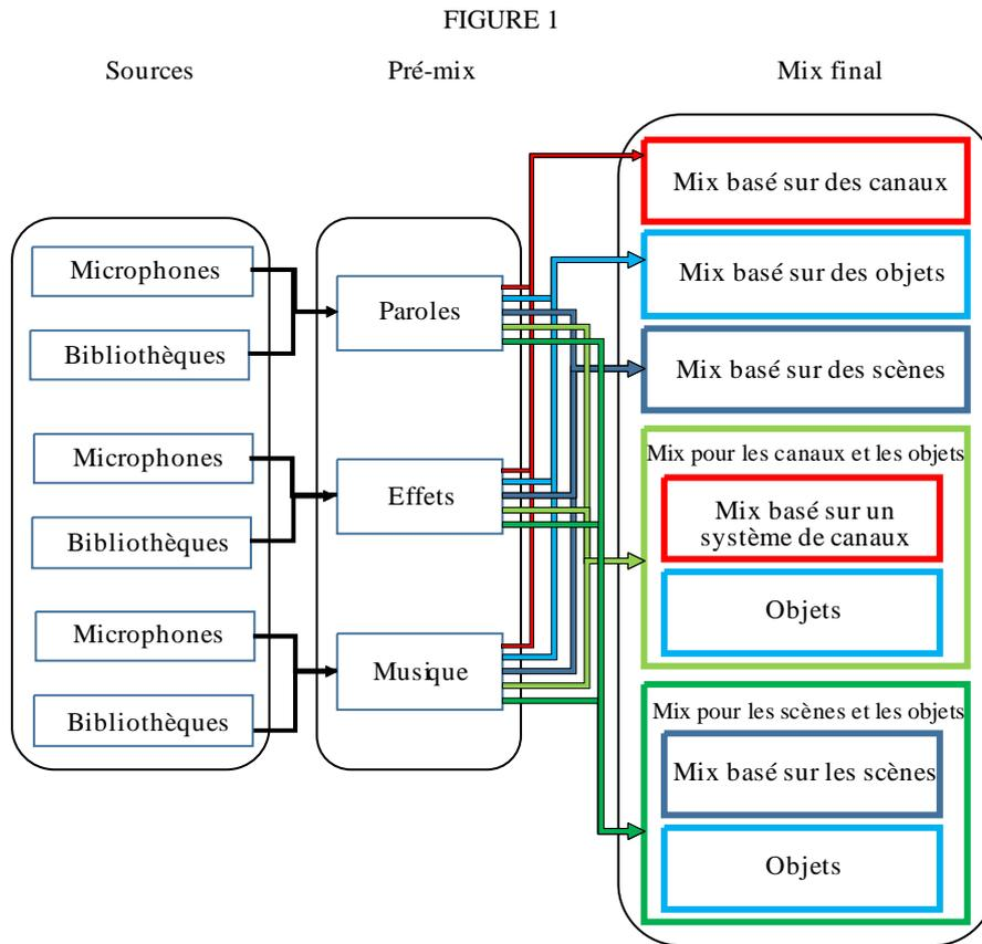
La Figure 2 illustre un exemple de chaîne de radiodiffusion type pour un système sonore évolué. La production peut utiliser n'importe quel type de source ou de contenu audio, mais il convient de procéder à une annotation complète au moyen des métadonnées correctes pour décrire les signaux audio, et on utilise pour le stockage un format de fichier qui peut prendre en charge ces métadonnées.
