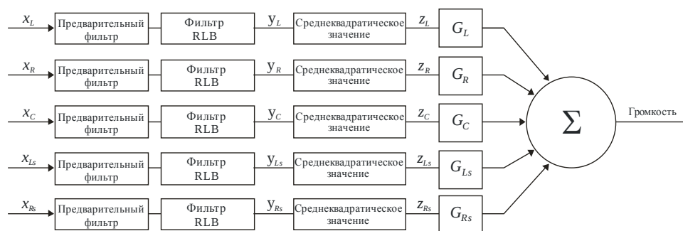
Блок-схема предлагаемого многоканального измерителя громкости
