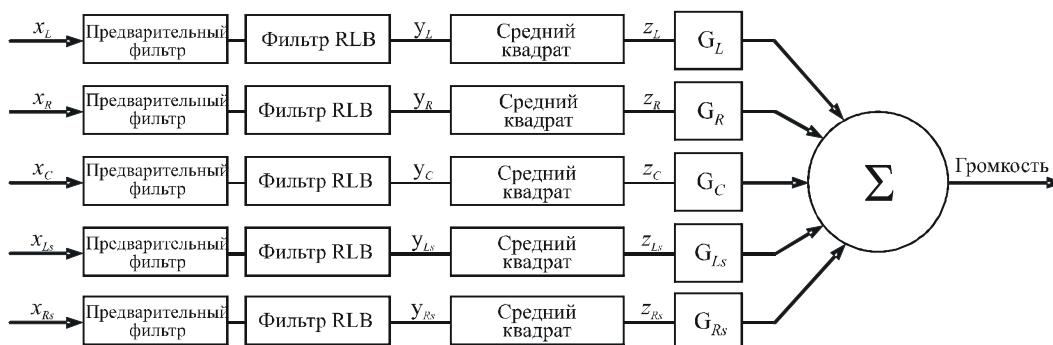
Блок-схема алгоритма многоканального измерения громкости
