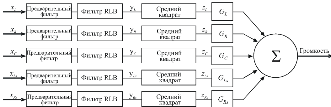
Блок-схема предлагаемого многоканального измерителя громкости
