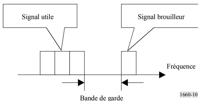
5.2 Signal ISDB-T<sub>SB</sub> brouillé par un signal de télévision analogique (NTSC)5.2.1 *D/U* requis pour la réception fixe
