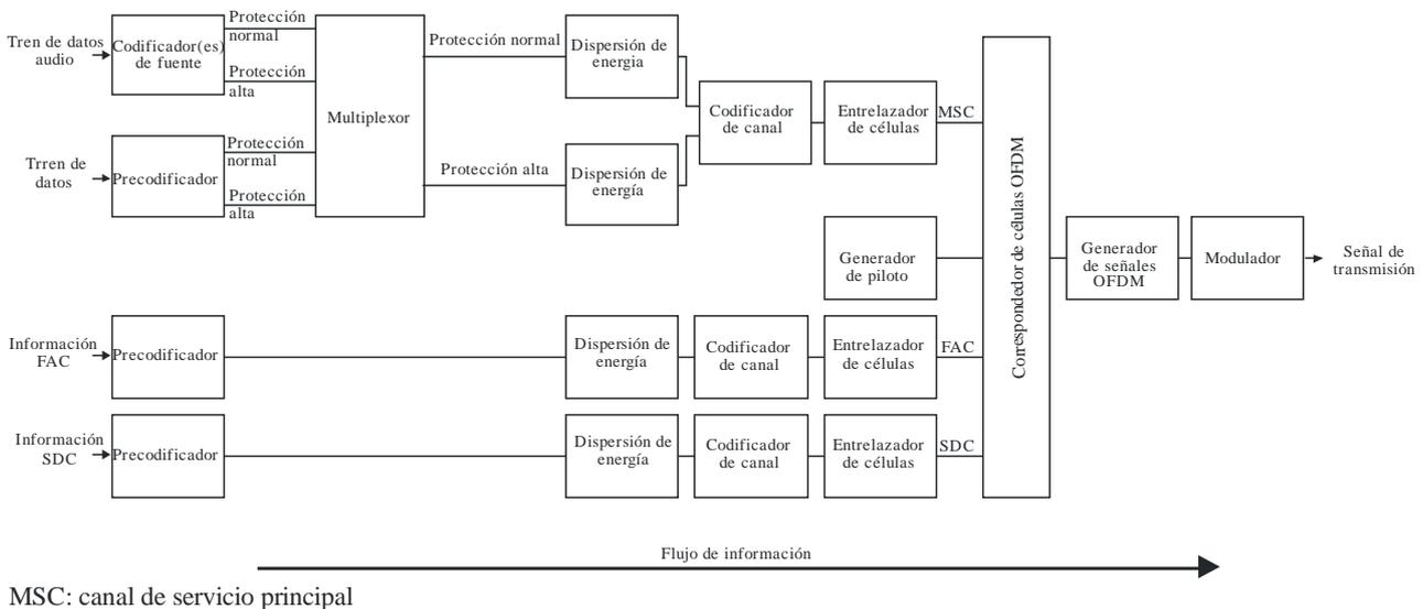
La Fig. 1 describe el flujo general de las diferentes clases de información (audio, datos, etc.) desde la codificación, a la izquierda de la figura, hasta un transmisor de sistema DRM, a la derecha. Aunque no se incluye una figura con un diagrama del receptor, éste sería el diagrama inverso.
