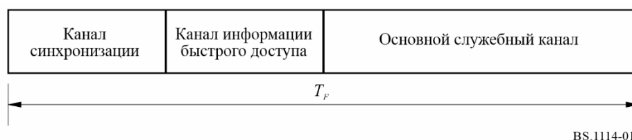
РИСУНОК 1 Структура цикла уплотненного сигнала
