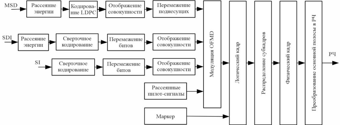
РИСУНОК 45 Блок-схема кодирования каналов и модуляции
