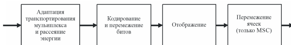
Функциональная блок-схема кодирования и перемежения
