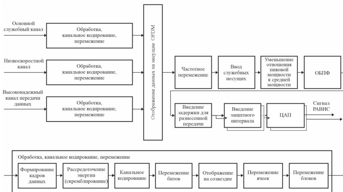
Функциональная блок-схема передатчика РАВИС
