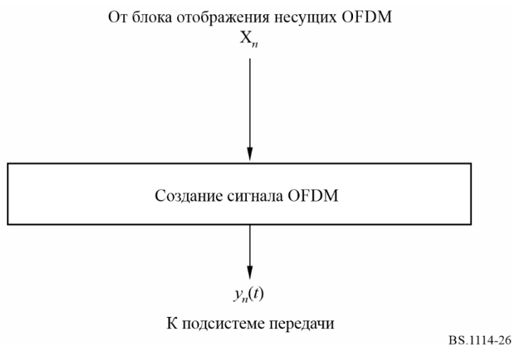
РИСУНОК 26 Концептуальная блок-схема создания сигнала OFDM
