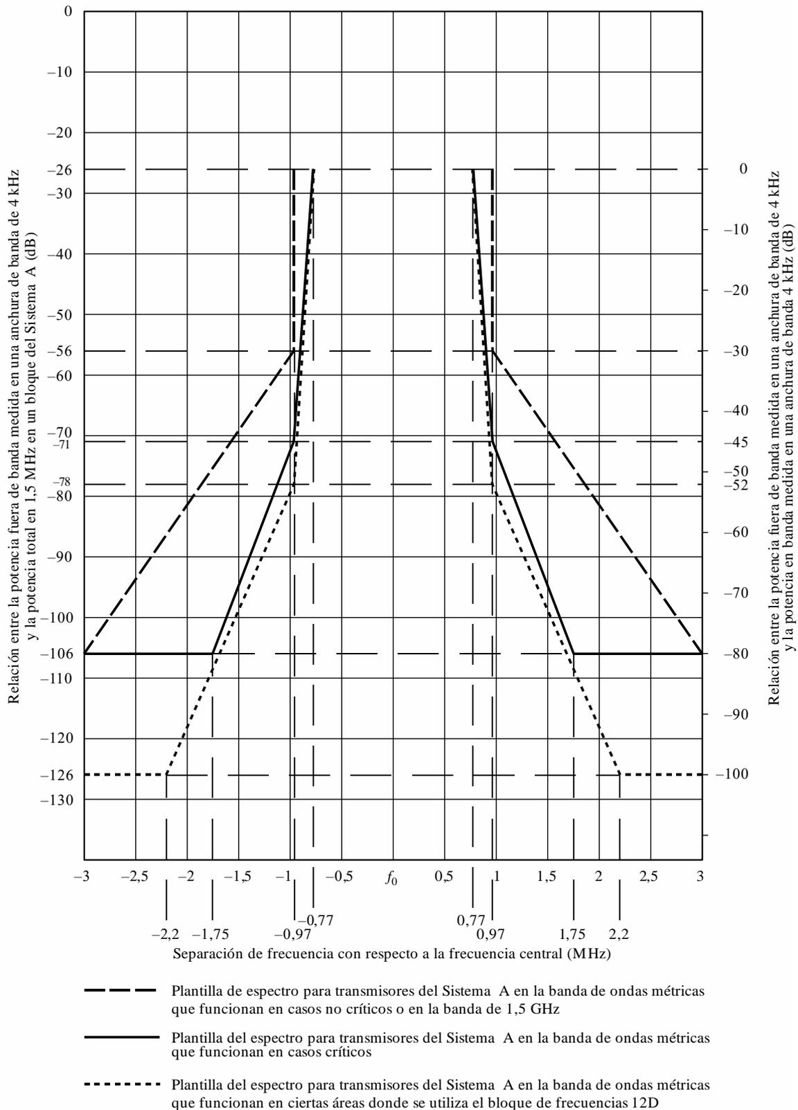
La plantilla de línea continua debe aplicarse a los transmisores en la banda de ondas métricas que funcionan en casos críticos. La plantilla de línea discontinua debe aplicarse a los transmisores en la banda de ondas métricas que funcionan en casos no críticos y la plantilla de línea de puntos debe aplicarse a los transmisores en la banda de ondas métricas que funcionan en ciertas áreas donde se utiliza el bloque de frecuencias 12D.
