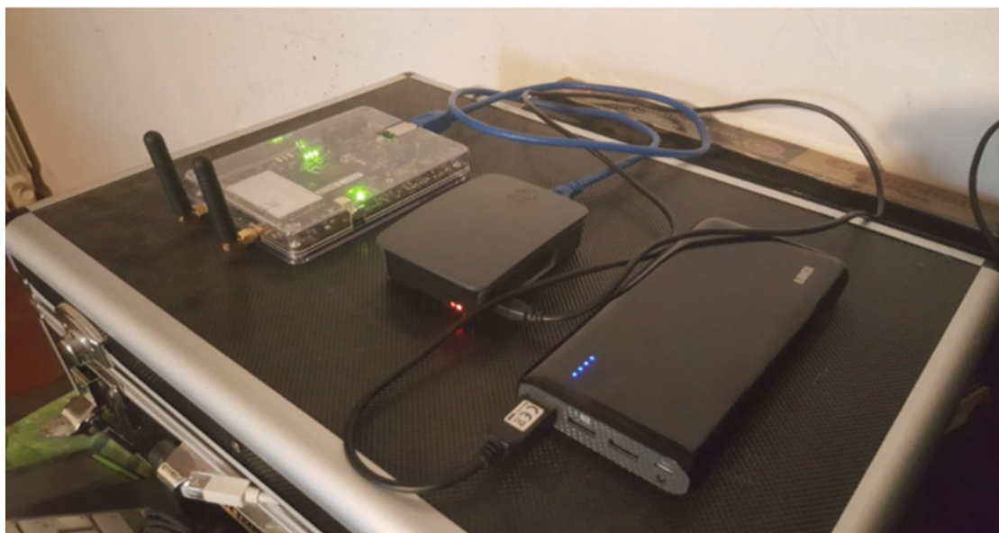
Figure 4 - Un système d'interception MITM rudimentaire fondé sur du matériel disponible dans le commerce et un logiciel à code source ouvert
