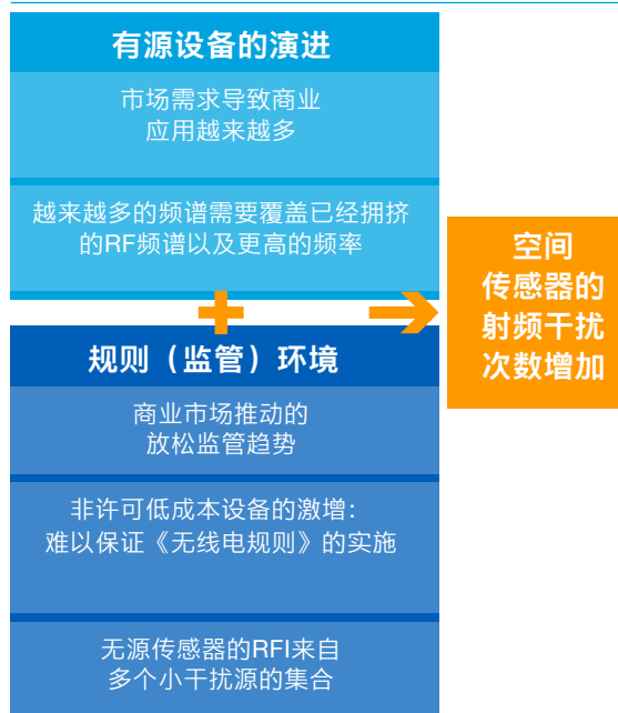
图5：到无源遥感内的RFI增加的原因
