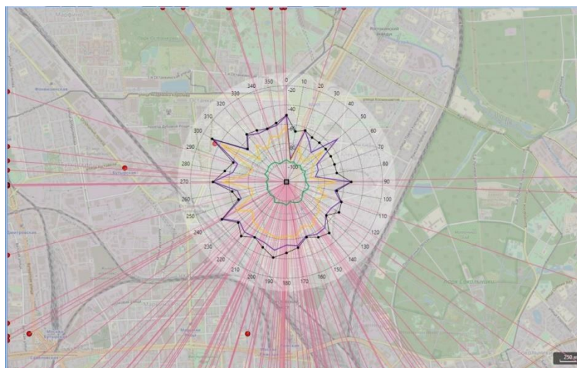
图7 基于测量数据的发射源方向（红线）
