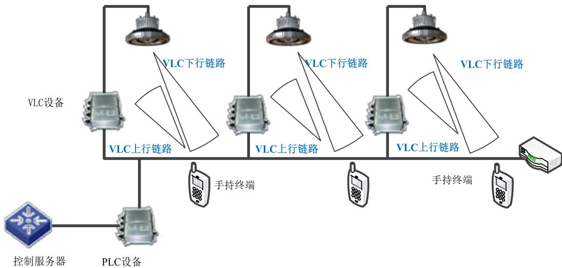
信息交换的要求包括固定传感器的数据传输和移动应用的数据传输。该系统可以将在线监测、视频监控、电缆接头的红外温度传感器集成设备、温度、风机、水泵、接地电流、火情、煤气与入侵报警和管道防御等感应设备结合，在线实时传输监测数据。监控数据的定期传输将更准确和及时地识别并帮助排除故障。此外还可以缩短抢修时间，减少相应损失。在此过程中，巡检人员可以利用该系统与控制中心保持数据交换和服务交互，从而大大提高在线监测的自动化水平以及巡检效率。
