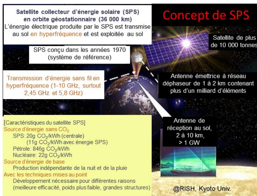
FIGURE 35 Satellite collecteur d'énergie solaire
