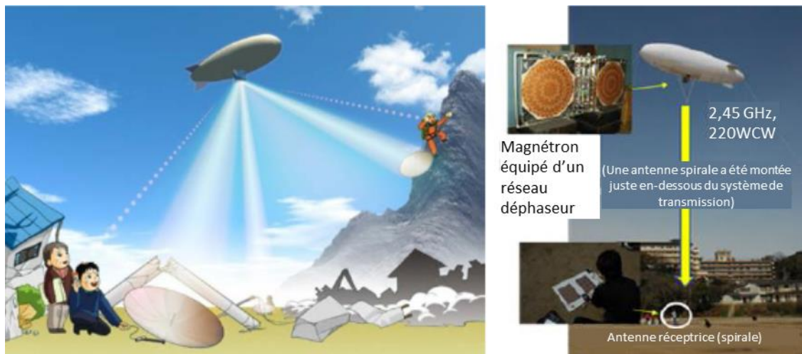
FIGURE 6 Illustration d'un système UPS d'urgence et photo de l'expérience (2009)
