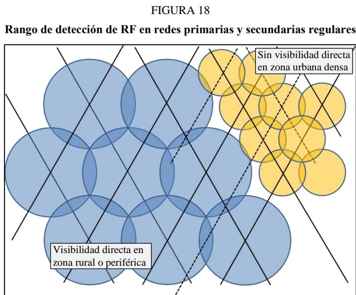
La superposición de los rangos de detección de RF de las estaciones de comprobación técnica crea una cobertura generalizada para las funciones de escucha y caracterización de emisiones, como se indica en el § 3.1 del presente Informe.
