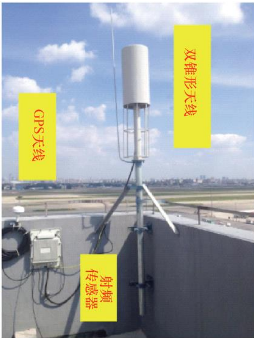
图A2-6 成本效益高的可联网射频传感器和双锥形天线
