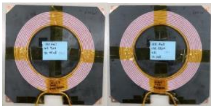
图 17 两层结构发射/接收线圈的示例
