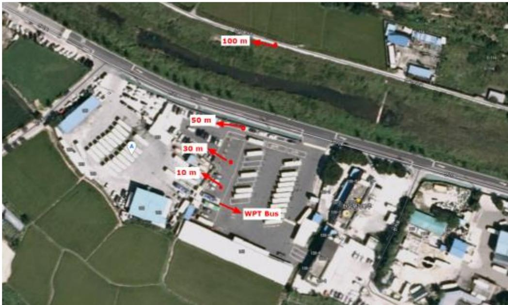
Les intensités du champ magnétique sont mesurées au moyen d'une antenne-cadre à quatre distances différentes d'un bus TESF sur la base d'une hauteur d'antenne de 1,5 m, comme indiqué à la Fig. A4-2.
