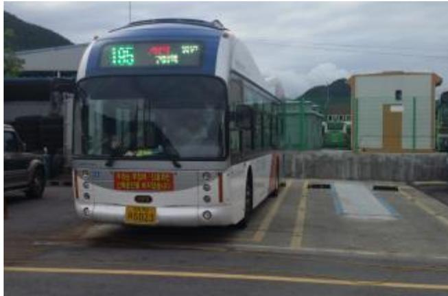
Ce test est réalisé dans les conditions suivantes: 125 A et 680 V (puissance de recharge: 85 kW), puissance principale: 99,26 kW, efficacité de recharge: 85,6%, et fréquence 20 kHz.
