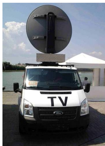
FIGURA A7.19 Estación de comunicaciones Tierra-satélite en el Centro de Deportes AkBure
