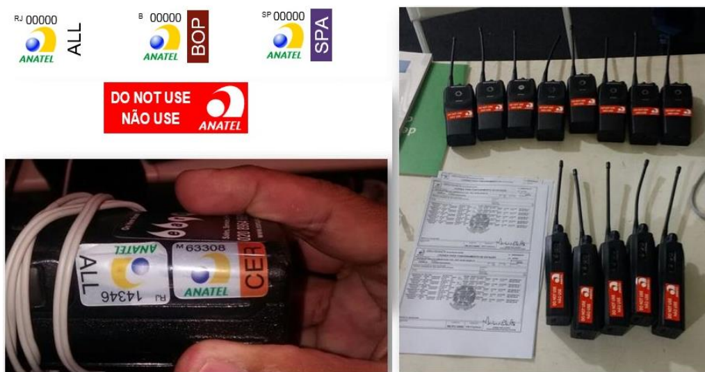
标签、标有RF设备和标有“请勿使用” 红色标签的移动无线电的示例
