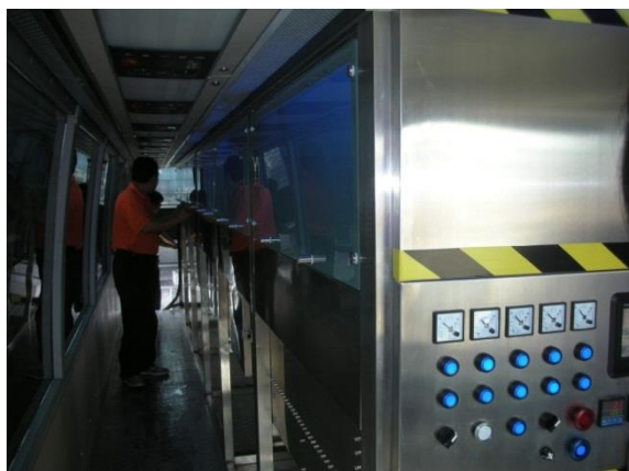
Внутренний вид двухканальной микроволновой печи
