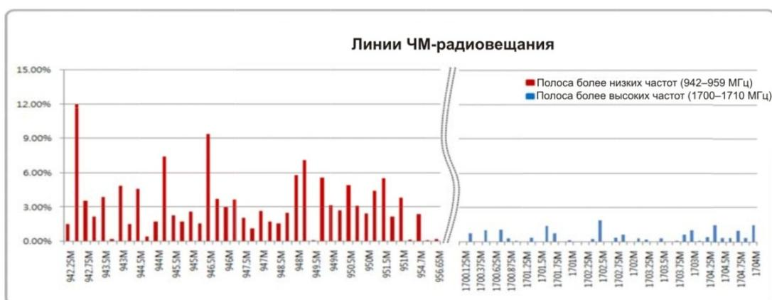
Расчетное значение SRO для нижней полосы частот составило 3,85%, а для верхней – менее 1%. На основе данного результата было принято решение об объединении всех служб с использованием линий ЧМ-радиовещания в верхней полосе частот, оставив нижнюю полосу для работы служб быстро развивающейся подвижной связи.
