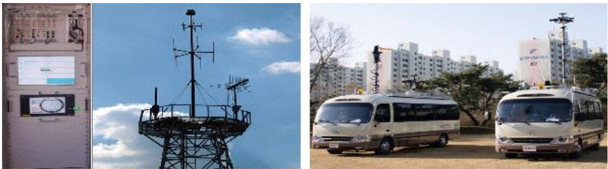
FIGURE 20 Systèmes de contrôle fixe (à gauche) et mobile (à droite) utilisés pour mesurer l'occupation spectrale
