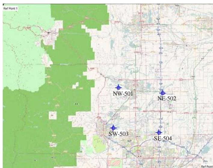
作为本节中的实例，采用了在美国科罗拉多州的一个地区，如图3所示。4个站（NW-501、NE-502、SW-503和SE-504）大约间隔18 km。模拟将演示独立工作的传统AOA和TDOA站的射频检测范围。出于此模拟的目的，检测范围被定义为距离能够以正SNR检测到一个发射源的监测站的最远距离（以km为单位）。
