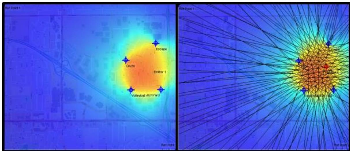
图15（左）显示了期望的地理定位覆盖区域（假设有高达4对传感器的相关）和到该发射源位置的双曲线。右侧图显示了该发射源的实际测量。在此位置进行了多个测量，TDOA误差小于50 m。
