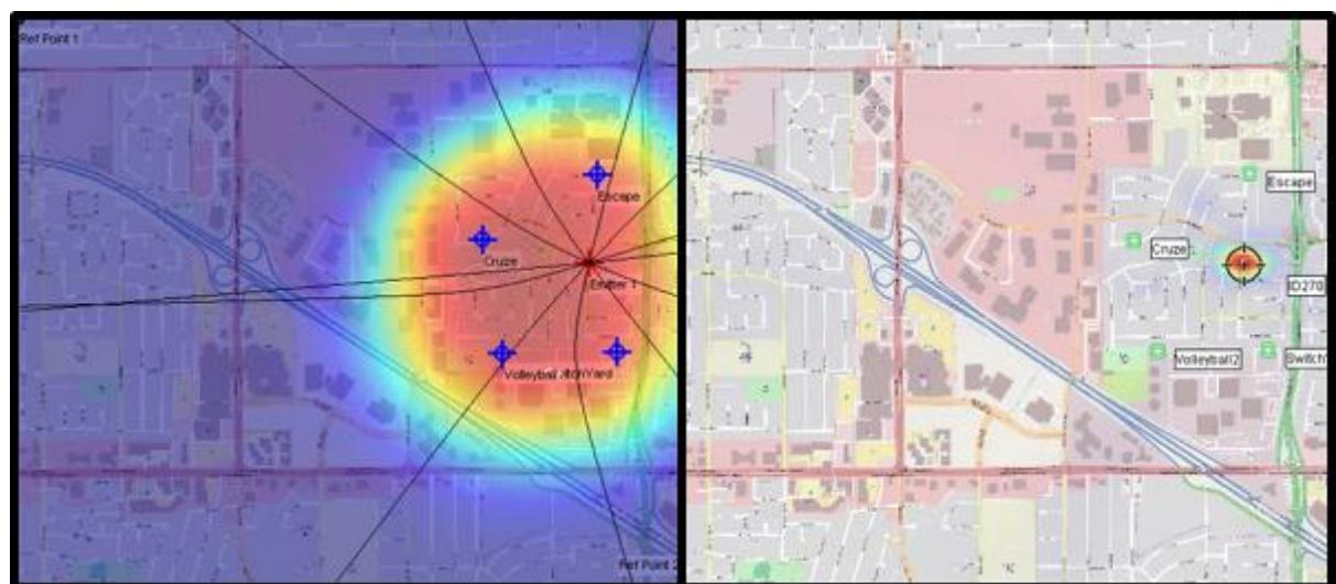
图16以对可能性、椭圆误差概率（EEP）和估计的发射源位置（EP）的相关的染色方法在Google Earth ®上重叠显示了多个地理定位的结果。黄色的按钉显示了该发射源的实际位置。
