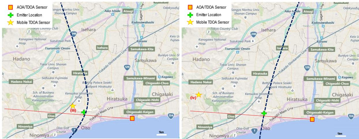
在 (i) 点上计算的记过并未显示出一个有效的位置，因为计算的时间差超过了TDOA传感器之间无线电波传输的时间。
