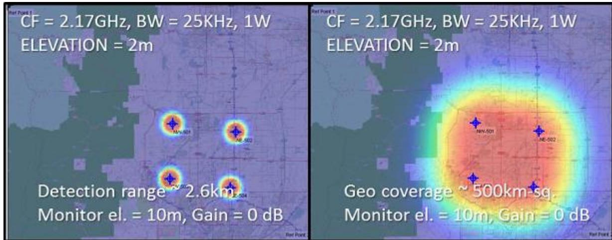
图12显示了一个模拟的结果，它将发射源的高度提升到10 m。这显示了AOA和TDOA系统改进的射频检测范围。TDOA地理定位覆盖区域（在右侧）也被增强。在这个模拟中的一个重要考虑是与该站相对于发射源位置的几何关系相关的几何精度因子（GDOP）。它被用来陈述测量数据中的误差将如何影响定位的最终估值（它被以图形显示在第5章的图14中）。TDOA网络的GDOP随着发射源位置移出监测站所圈定的区域而增加。因此，预期TDOA精度在传感器网络之外降低。尽管该模拟显示了一个大的区域，其中地理定位测量是可行的，但它未显示GDOP对期望精度的影响。
