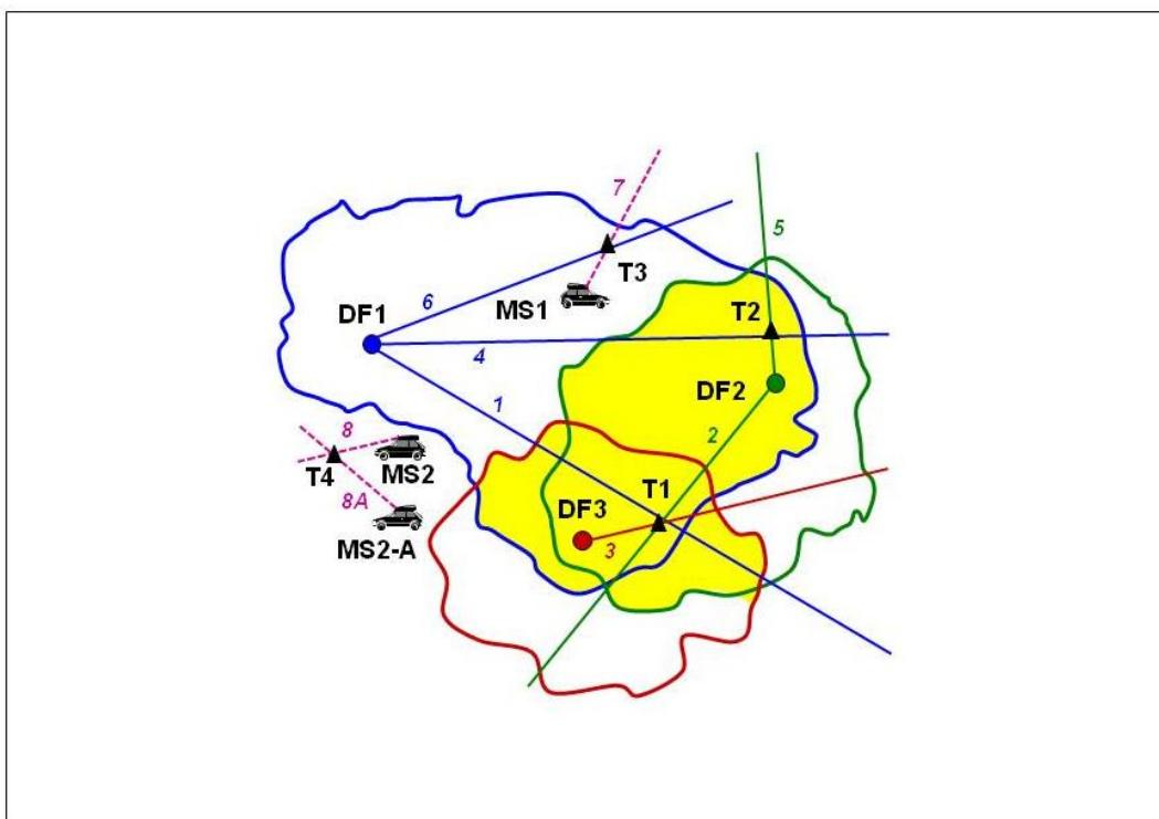
如果在一个TDOA网络中，所涉及的发射机位于传感器边界（图1中为棕色）之外区域之一，该系统可能仅仅产生一条位置线，如与发射机T2有关系的线2-1所描绘或者由指向该发射机的一条方位线所描绘。在这种情况下，该发射机的坐标必须借助一个移动站（图1中的MS1），通过与二个固定传感器相互作用来确定。这在图1中通过位置线2-1与由这个移动站所建立的其他二条位置线（位置线A和B，采用虚线来描述，以强调它们随着该站的四处移动所产生的可变性）的交点所示。
