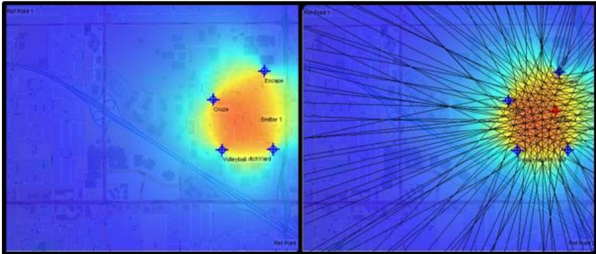
La Fig. 15 (izquierda) muestra la zona de cobertura de la localización geográfica esperada (suponiendo correlación de hasta cuatro pares de sensores) y las líneas hiperbólicas al emplazamiento del emisor. La Figura de la derecha muestra una medición real del emplazamiento del emisor. Se realizaron varias mediciones en este emplazamiento con un error TDOA inferior a 50 m.
