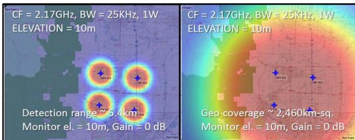
Las ganancias de procesamiento logradas por algoritmos TDOA avanzados pueden proporcionar capacidades de localización del emisor en una zona más amplia que la distancia de detección en RF de las estaciones individuales.
