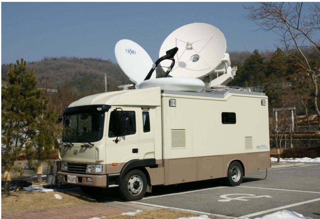
Передвижная система контроля спутниковой радиосвязи
