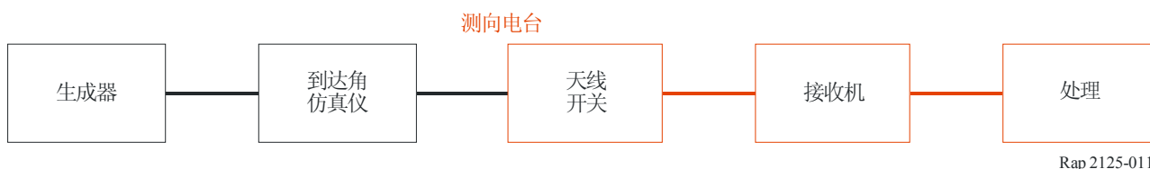
测向电台的接收链灵敏度测量设置
