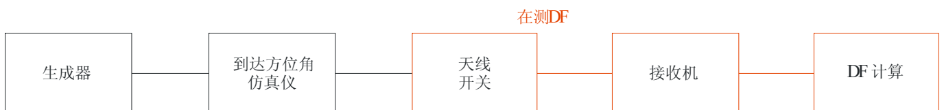
平台测向电台的DF精度测量设置
