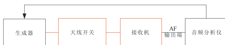
图 10 监测电台的接收链灵敏度测量设置
